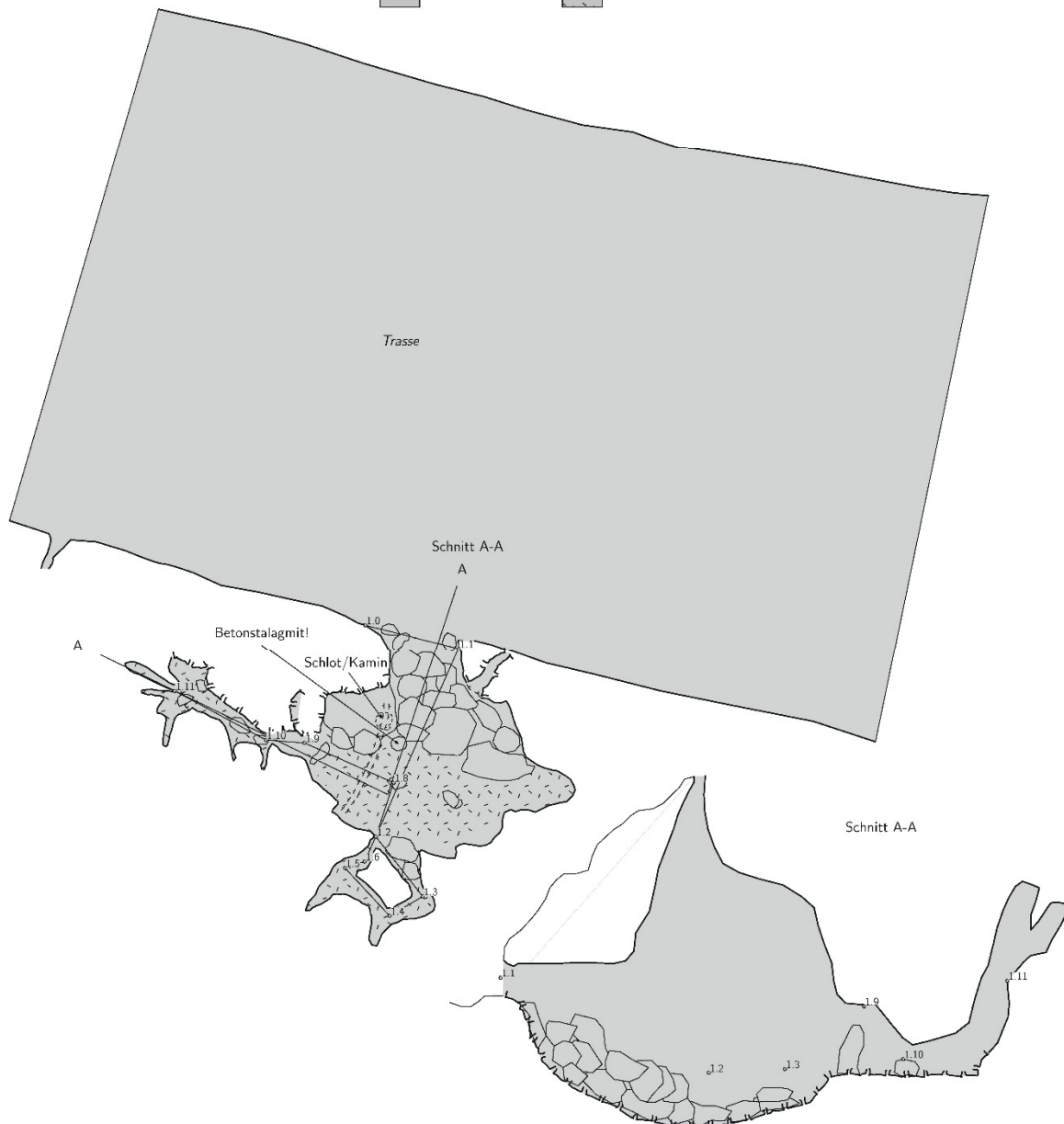
Plan der Trassenhöhle 1 – Darstellung der 39 Meter langen Höhle im Grundriss und in einem Schnitt (Zeichnung: M. Boldt; Vermessung am 19.03.2015 durch M. Boldt, P. Boldt, B. Hugger, W. Scheuerle & A. Scheurer).
